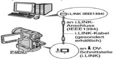
Sie müssen für diese Funktion ein i.LINK-Kabel (gesondert erhältlich) verwenden. Ein USB-Kabel (mitgeliefert) können Sie nicht verwenden. \* Beachten Sie, dass Sie einen VAIO-Computer von Sony benötigen, der mit einem DVD-Laufwerk ausgestattet ist, mit dem DVDs beschrieben werden können. Auf dem Computer muss außerdem "Click to DVD Ver.1.2" (Original-Software von Sony) oder höher installiert sein.
