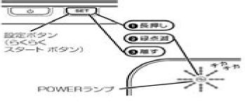
3 POWER ランブが緑点減になって から 1 分以内に、細い棒状のもの (つまようじなど電気を通さない 材質のもの)でRESET スイッチ を押し(約 1 秒)、すぐに離す
