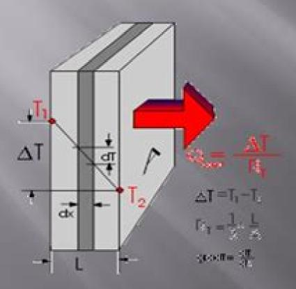
La conduzione termica avviene in mezzi solidi, liquidi e gassosi dalle zone a temperatura maggiore verso zone a temperatura minore.
