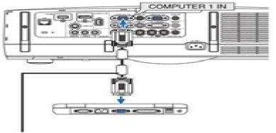
Supplied computer cable (VGA) کیل الکسیوٹر (VGA) المرفق
