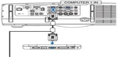
Supplied computer cable (VGA) كبل الكسيوتر (VGA) المرفق
