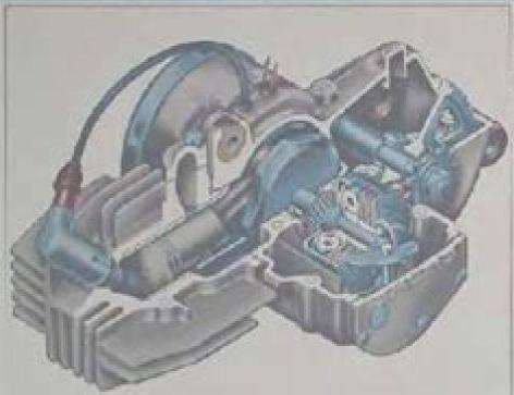
Fabrtwindgekühlter Einzylinder-Zweitakt-Otto-Motor 1-Gang-Automatik
