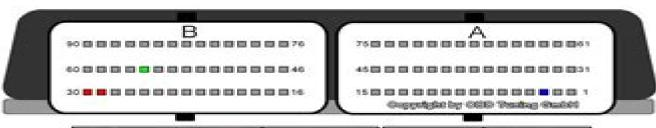
Voc/Power/+12Volt (30) B - Pin 29,30 K-Line B - Pin 55
